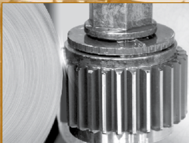
Шлифование зубьев сателлита планетарной передачи
