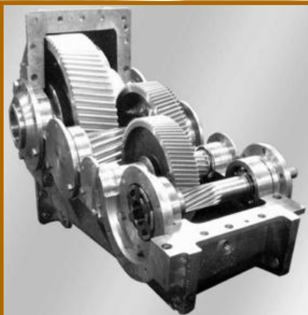
Редуктор ЦЗВН-400 в процессе сборки
